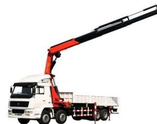
La grue auxiliaire est une grue à bras articulé et/ou télescopique disposée sur un véhicule.
